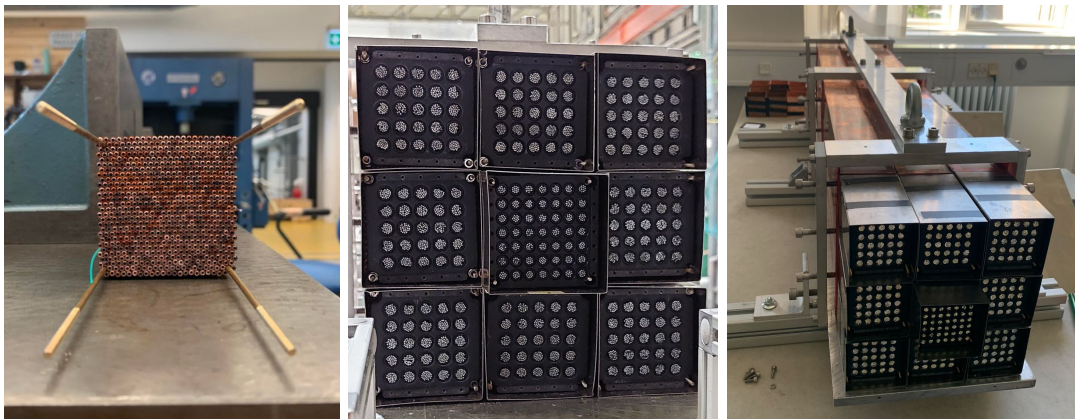
Фигура 4.1: Изображения на прототип 2 на адронния калориметър FoCal-H от процеса на подготовка за монтаж. Показани са: Модул на прототип 2 - изграден от 668 медни тръбички и 4 месингови пръчки за монтиране (ляво). Групиране на сцинтилационни влакна в снопове с помощта на пластмасова решетка център . Прототип 2 подготвен за монтиране дясно .
