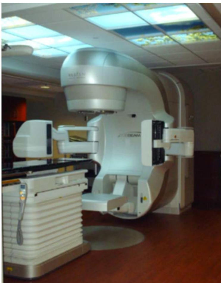
Фигура 9 Линеен ускорител Varian TrueBeam и неговата EPID система - панела с MV детектори и ортогонално разположената система от kV-източник и детектор (2)
