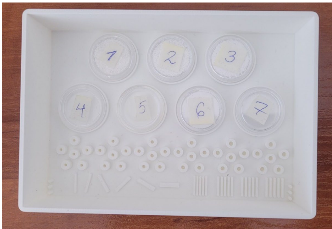
Фигура 5. Реална снимка на 3D-принтирания фантом
