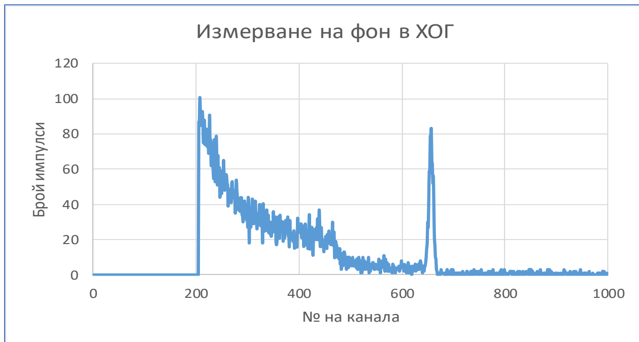
Фиг 13. Фоново измерване в ХОГ чрез гама-спектрометрична апаратура (МСА-527)
