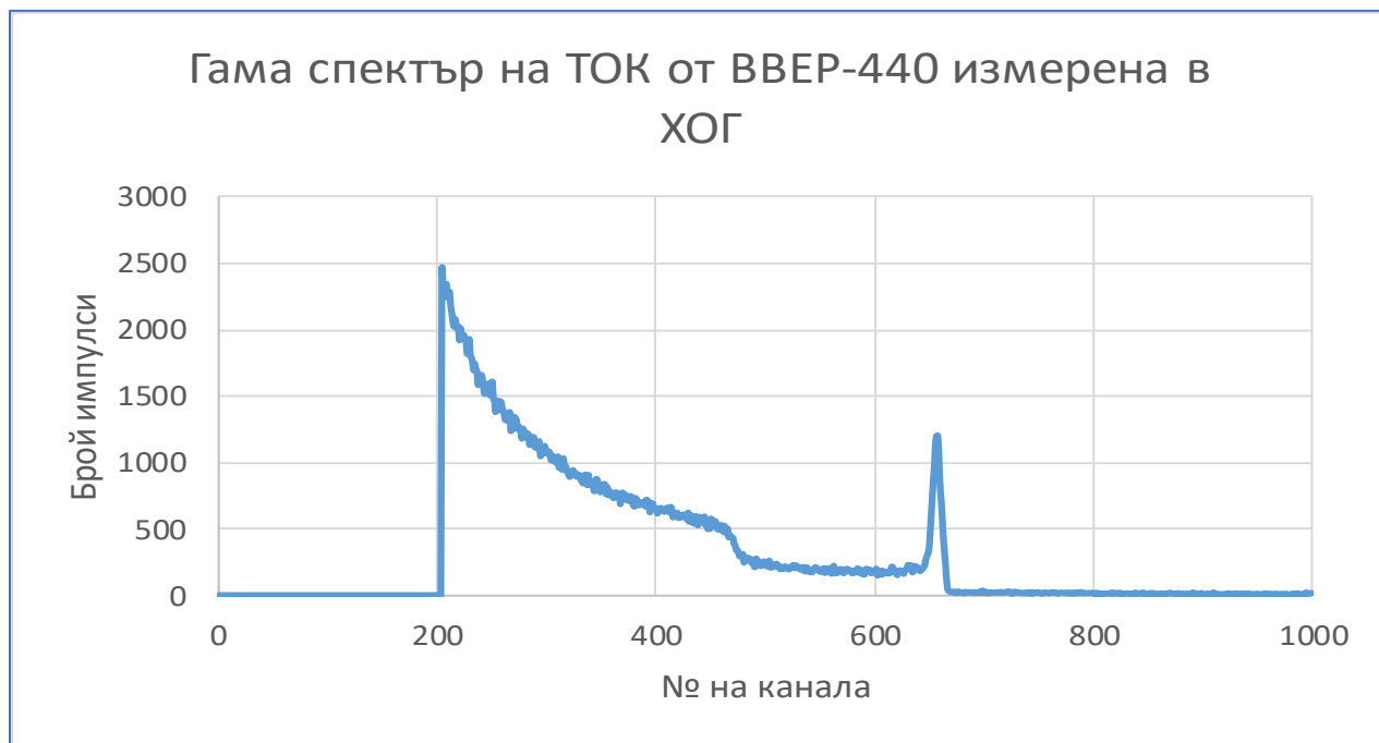
Фиг 14. Гама спектър на ОТОК от ВВЕР-440 измерена в ХОГ с наличната спектрометрична апаратура
