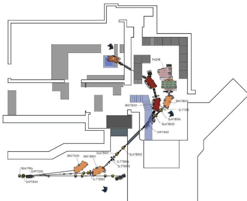
Фигура 2.2: Схема на комплекса за тестване на детектори BTF. В края на едната линия е разположен експериментът PADME [133].
