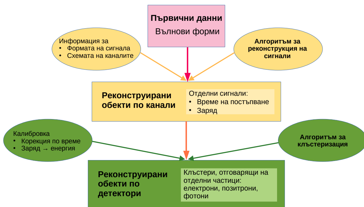
Фигура 2.26: Обща схема на процеса на реконструкция на данните в експеримента PADME. От първичните необработени вълнови форми за всеки канал на отделните детектори се извличат времената на пристигане на сигналите и тяхната енергия. Тези сигнали след това се групират в клъстери, които дават момента на пристигане и енергията на частицата в детектора.
